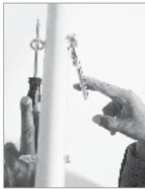
图9：用两根手指紧固螺栓
