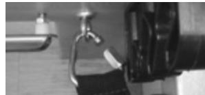
图2：状况良好的搭扣：挂钩没有磨损
