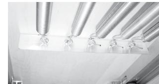
Figura 3: Resortes enganchados hacia abajo
