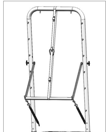
**Hinweis:** Verwenden Sie den oben am Tower-Rahmen befindlichen Klettverschlussteil des Sicherheitsgurtes zur Sicherung der PTS, wenn diese nicht verwendet wird.
