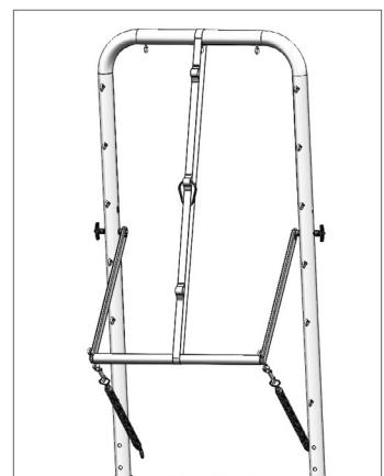
**Obs:** Använd säkerhetsremmerns kardborrfäste högst upp på tornramen för att säkra PTB:n när den inte används.
