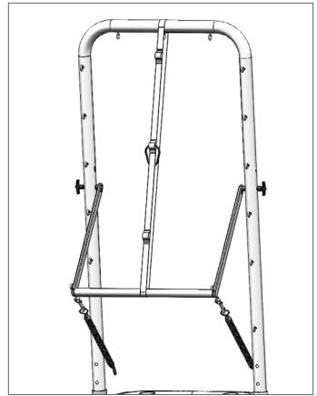
**Remarque:** Utilisez la partie velcro de la sangle de sécurité en l'orientant vers la partie supérieure du cadre de la Tower pour fixer la PTB à la verticale lorsque celle-ci n'est pas utilisée.
