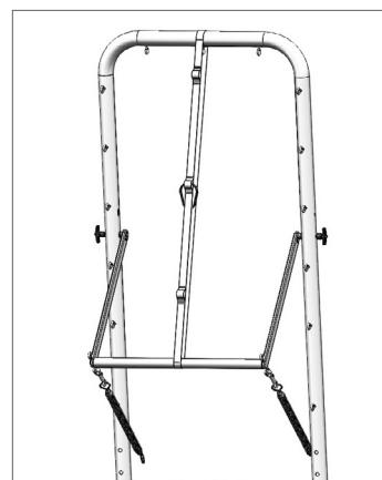
**Nota:** Utilice la parte con Velcro de la correa de seguridad orientada a la parte superior del marco de la torre para fijar la PTB en posición vertical cuando no esté en uso.
