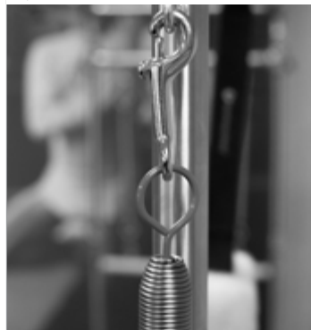
Point d'attachement « œil de vis et boucle » trouvé sur les Cadillacs, les unités murales et les tours.
