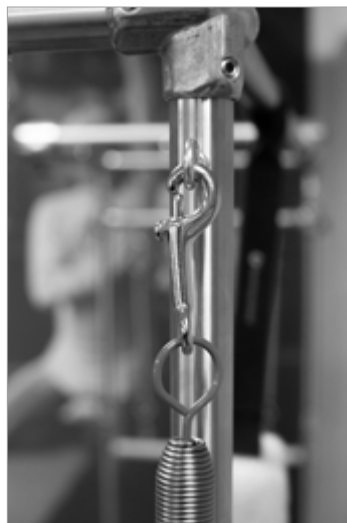
Punto de fijación de la argolla y el mosquetón encontrado en Cadillacs, unidades de pared y torres.
