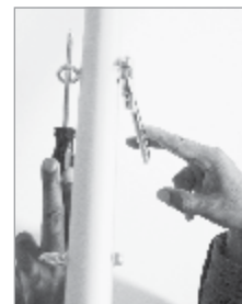
Figura 9: Usare due dita per stringere i bulloni
