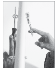
Figura 9: Usar dos dedos para apretar los tornillos.
