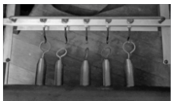
Punto de fijación "Hook" se encuentra en las barras de resorte/muelle Revo, barras de resorte/muelle estándar y algunas versiones del Allegro Reformer. Note los postes en forma de reloj de arena en la sección superior de esta barra de resorte/muelle como una posición de precarga, mostrada aquí sin los resortes/muelles adjuntos.
