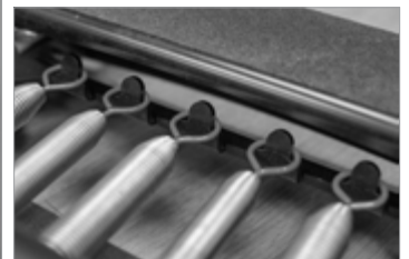
Point d'attache du ressort « Reformer Cactus » présent sur les modèles IQ, Metro IQ et une version de l'Allegro Reformer. Il peut présenter des encoches et des courbures à la base des cactus.
