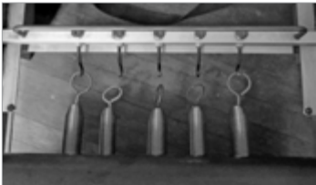
Punto di attacco "Hook" trovato su barre a molla Revo, barre a molla standard e alcune versioni dell'Allegro Reformer. Nota i perni a clessidra nella sezione superiore di questa barra a molla come posizione di pre-carico, mostrata qui senza le molle attaccate.
