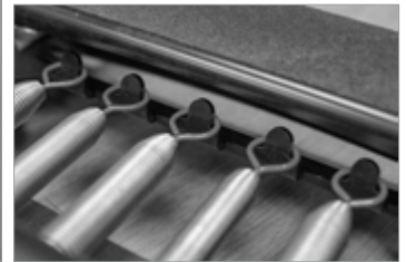
Punto di attacco della molla "Reformer Cactus" trovato su IQ, Metro IQ e una versione del Allegro Reformer. Può avere o meno tacche e pieghe alla base dei cactus.
