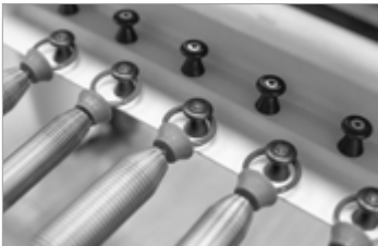
„Sanduhr“ Federbefestigungspunkt gefunden am Allegro 2 und einigen Versionen des Allegro Reformers, sowie den oberen (Vorlast) Befestigungspunkten an einer Revo-Federstange.
