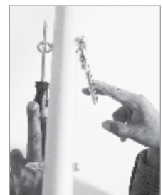
Abb. 9: Mit zwei Fingern die Schrauben festziehen
