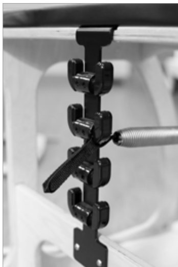
Point d'attachement « Chair Cactus » trouvé sur diverses chaises. Il peut également être plus plat et en tôle.
