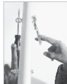
Figura 9: Usare due dita per stringere i bulloni
