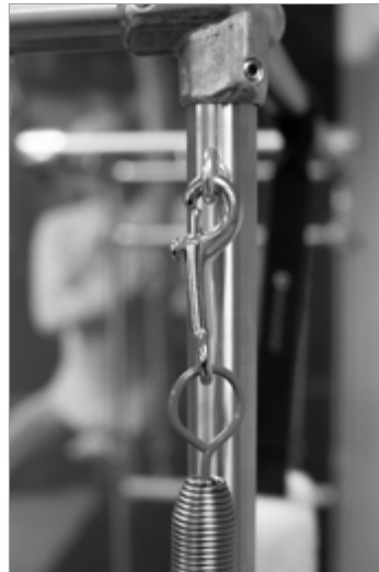
Ösen und Schlaufenbefestigungspunkte, die bei Cadillacs, Wandgeräten und Türmen zu finden sind.
