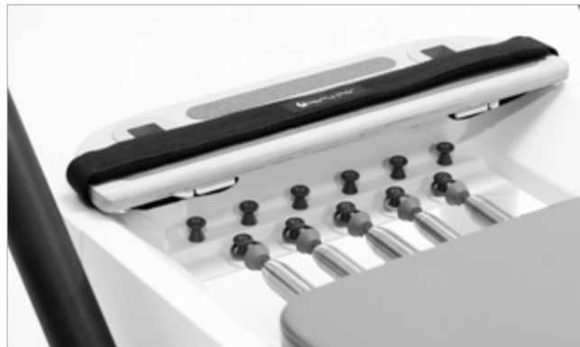
Vérifiez régulièrement l'état des ressorts et remplacez-les si nécessaire. Nous recommandons de remplacer les ressorts tous les deux ans (une fois par an pour les cours de fitness en groupe).
