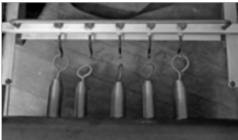
„Haken“-Befestigungspunkt gefunden an Revo-Federstangen, Standard-Federstangen und einigen Versionen des Allegro Reformers. Beachten Sie die Sanduhrpfosten im oberen Abschnitt dieser Federstange als Vorspannungsposition, hier ohne befestigte Federn gezeigt.
