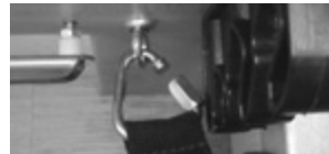
Abb. 2: Schnappverbindung: keine Abnutzung am Haken.
