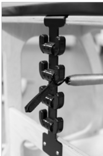
El punto de fijación "Chair Cactus" se encuentra en varias sillas. También puede ser más plano y estar hecho de chapa metálica.
