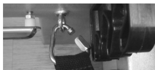
Figure 2 : mousqueton correct : Aucune usure du crochet.
