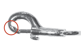
状况不好的搭扣：挂钩过度磨损
