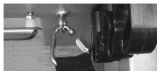
Figure 2 : mousqueton correct : Aucune usure du crochet.
