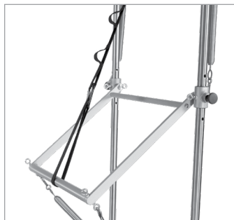
Figura 6: Correo de seguridad que sujeta la barra de empuje en la posición de 4 en punto. La correa se sujeta a la PTB y al marco de la cubierta, no a los cáncamos.
