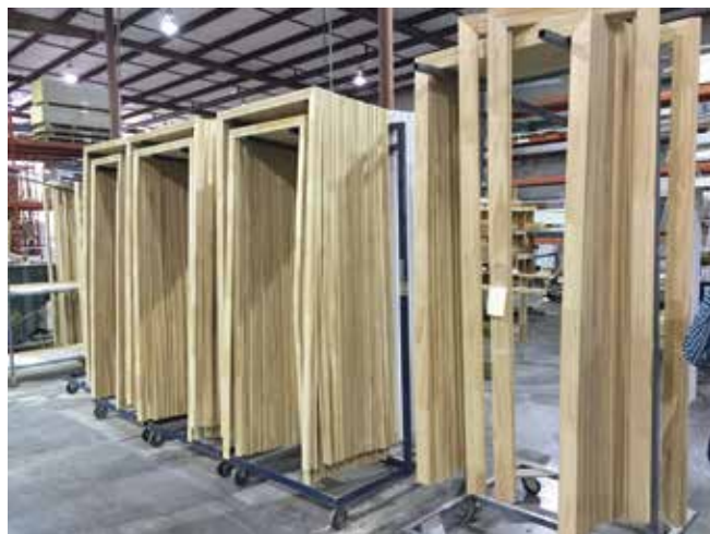
Produce 3 casing hoops per minute
