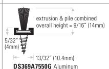
DS369A7550G Aluminum extrusion mill finish with fin pile insert, grey
