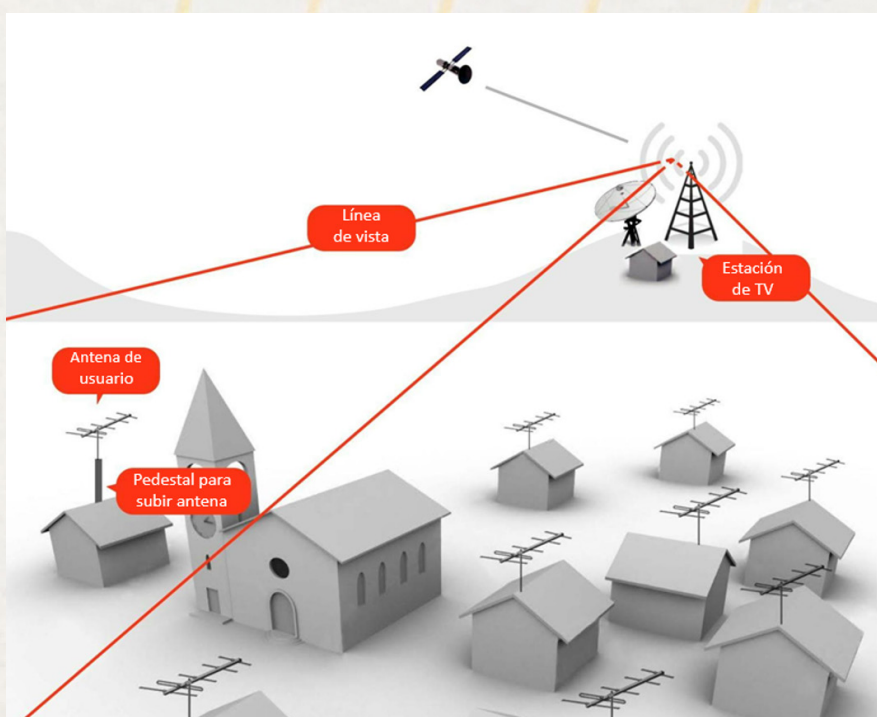
Fig. 9 Direccionamiento de antenas
