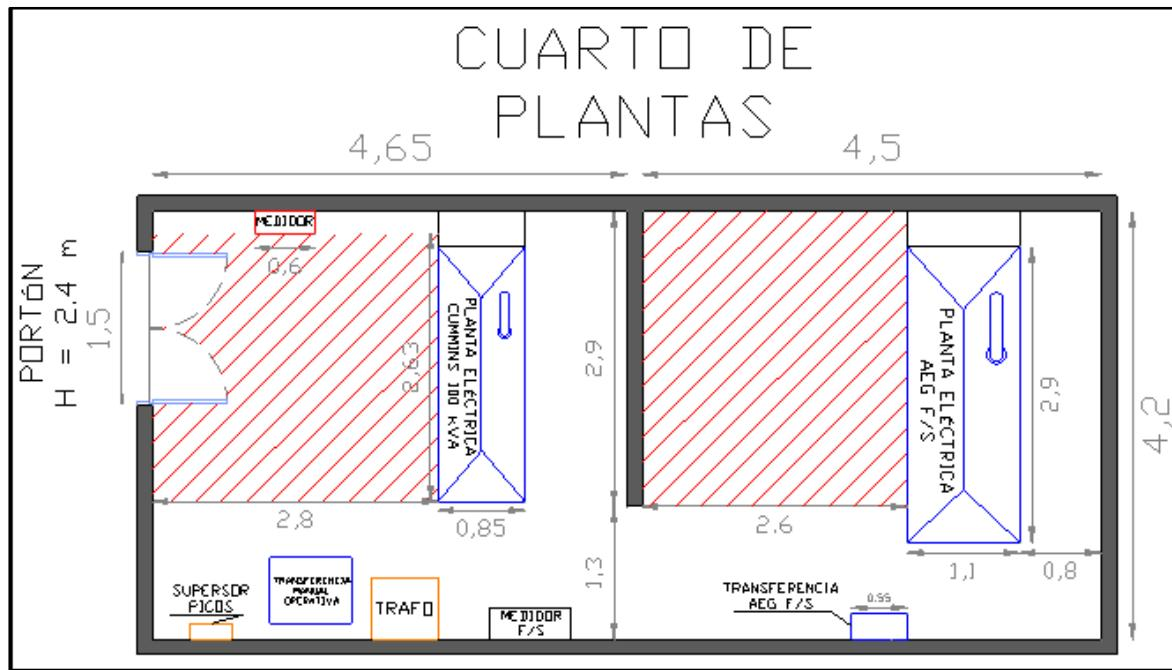
El área disponible para la implementación de la planta de emergencia, el tanque de reserva y los elementos asociados, es de aproximadamente 15 m<sup>2</sup>, y se muestra en las secciones demarcadas con los recuadros rojos del gráfico anterior. Para esta instalación se deben realizar adecuaciones menores.
