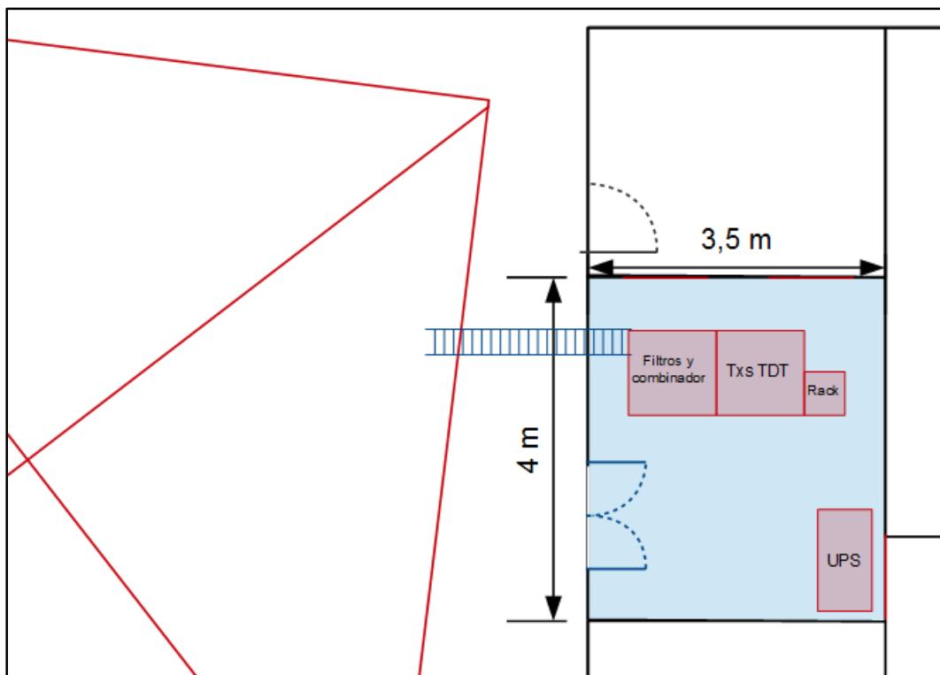
Para la instalación de los equipos y elementos de los sistemas de transmisión, recepción satelital y la UPS, RTVC dispone de un área de 14 m<sup>2</sup> incluyendo el espacio para operación y mantenimiento. El área total se señala en el gráfico anterior, donde se marca en rojo las zonas potenciales para la instalación de los equipos y elementos en mención. El **Contratista** debe realizar adecuaciones previas en el cuarto para la correcta instalación y puesta en operación de los equipos.
