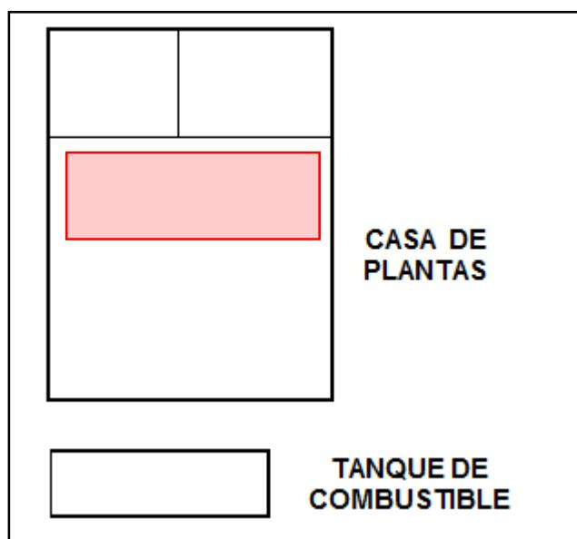
Para la instalación de la planta de emergencia **RTVC** dispone de un área mínima en el cuarto de plantas de 6 m<sup>2</sup> fuera del espacio para operación y mantenimiento. Esta área se demarca con el recuadro rojo en el gráfico anterior. Se deberán realizar adecuaciones menores para las instalaciones en este cuarto.
