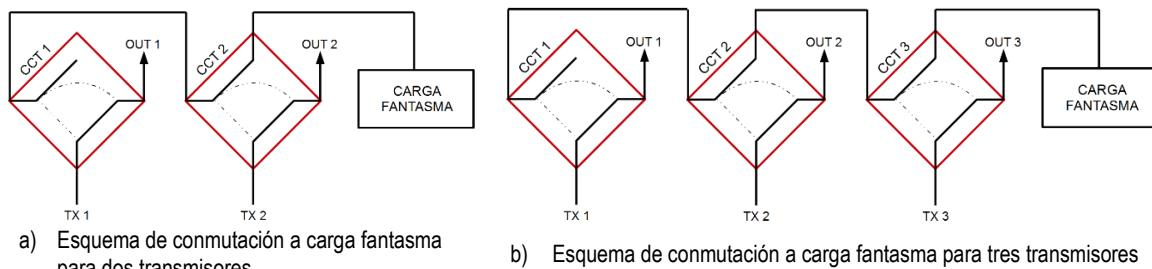
a) Esquema de conmutación a carga fantasma para dos transmisores
