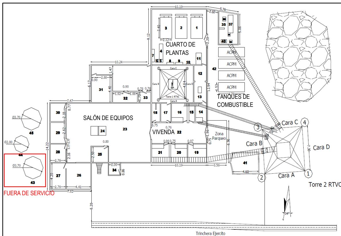
El **Contratista** debe desinstalar y desmontar la antena parabólica fuera de servicio que se encuentra ubicada en la zona señalada en el recuadro rojo del gráfico anterior, junto con los cables y elementos asociados ésta, para instalar en dicho espacio liberado la nueva TVRO junto con los demás elementos que se requieran para la recepción de las señales satelitales.
