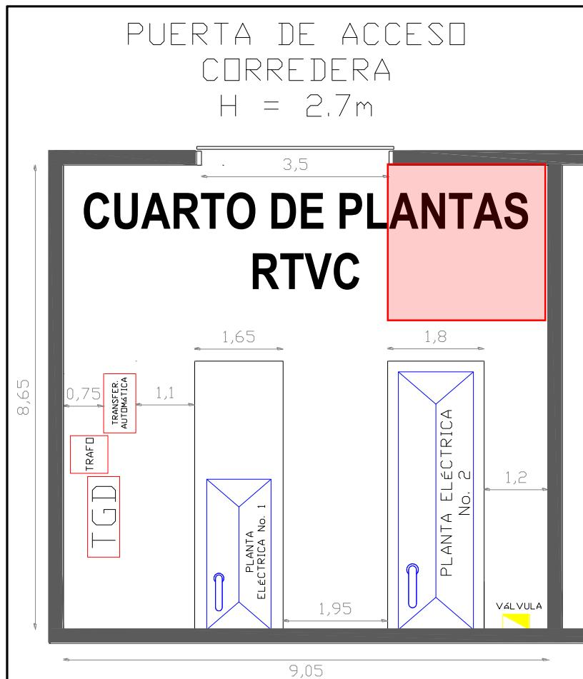
Para la instalación de la UPS, **RTVC** dispone de un área aproximada de 9 m<sup>2</sup> que se demarca con el recuadro rojo en el gráfico anterior. Se deberán realizar adecuaciones menores para las instalaciones en este cuarto.
