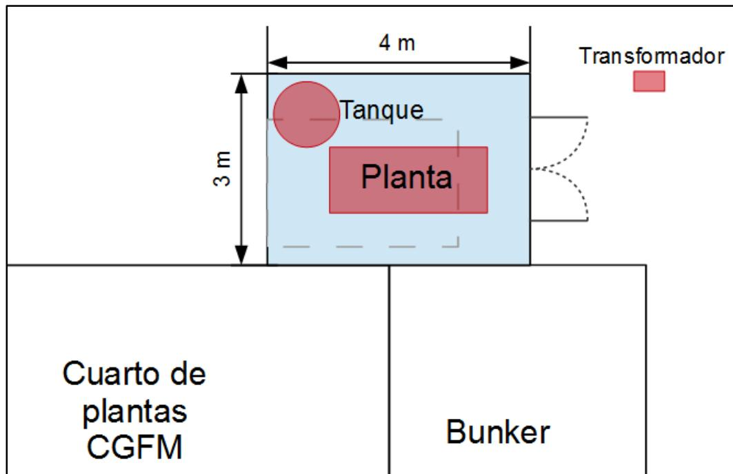
En el gráfico anterior se señalan las áreas potenciales para la instalación de la planta de emergencia, el tanque de reserva y el transformador. Se debe realizar la acometida eléctrica hasta el cuarto de equipos a través de ductos subterráneos.
