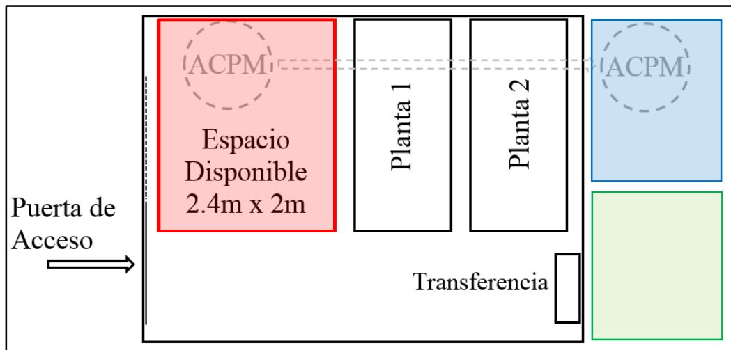
El **Contratista** debe reubicar, en el costado sur del cuarto de plantas, el tanque de combustible de 300 galones (1 metro de diámetro x 1,5 metros de altura) que actualmente se encuentra al interior de dicho cuarto, con el fin de liberar el espacio requerido para la instalación de la planta de emergencia y los elementos asociados a ésta, en la zona demarcada con el recuadro rojo en el gráfico anterior.
