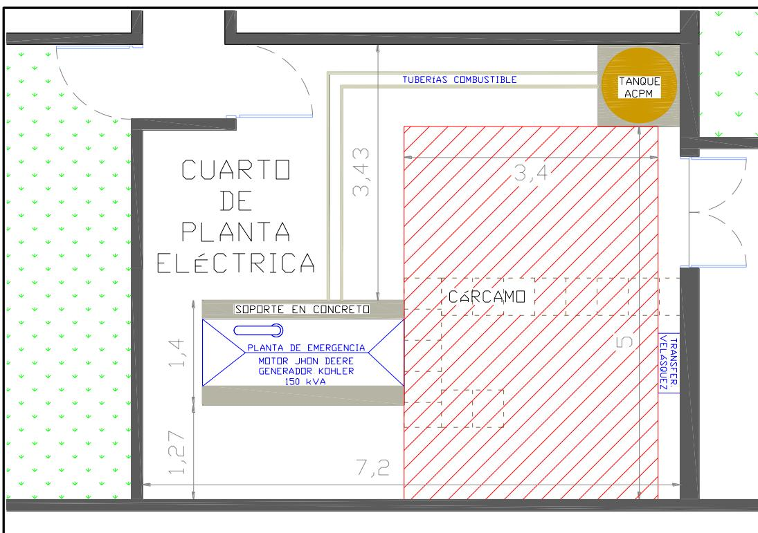
Para la implementación de la planta de emergencia, el tanque de reserva y los elementos asociados, **RTVC** dispone de un área de  $3 \text{ m}^2$  fuera de los espacios de tránsito y operación. El espacio a utilizar será dentro de la sección sombreada en rojo en el gráfico anterior. Para esta instalación se deben realizar adecuaciones menores.
