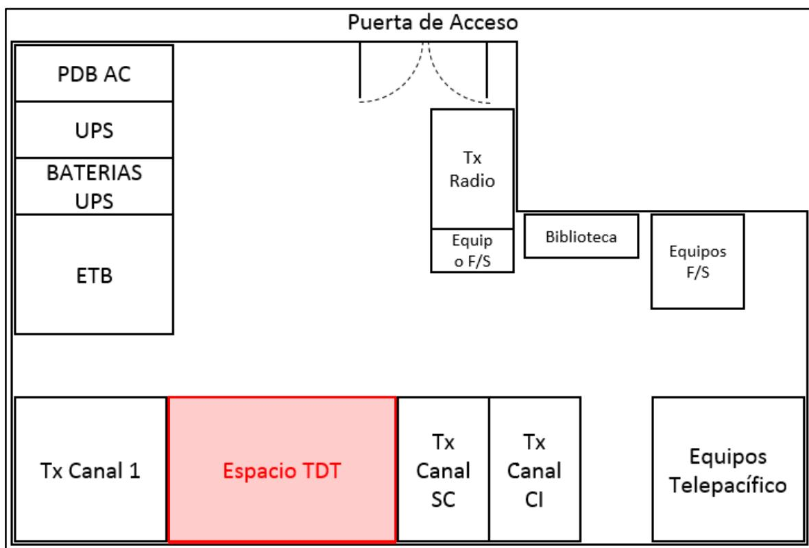
Para la instalación de los equipos del sistema de transmisión y recepción satelital, **RTVC** dispondrá de un área mínima de 8 m<sup>2</sup> fuera del espacio para operación y mantenimiento. Esta área se demarca con el recuadro rojo en el gráfico anterior. Se deberán realizar adecuaciones menores para las instalaciones en este cuarto.
