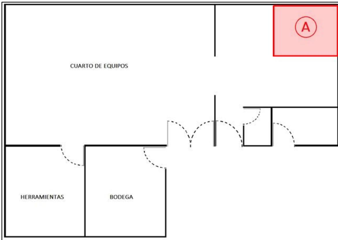
Para la instalación de los sistemas de transmisión y recepción satelital, **RTVC** dispondrá de un área mínima de 6 m<sup>2</sup> fuera del espacio para operación y mantenimiento. Esta área se demarca con el recuadro rojo en el gráfico anterior. Se deberán realizar adecuaciones menores para las instalaciones en este cuarto.
