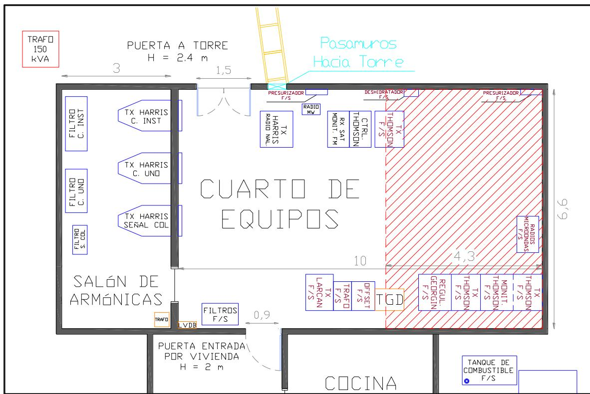
Para la instalación de los sistemas de transmisión, recepción satelital y la UPS, RTVC dispone de un área aproximada 28 m<sup>2</sup> (6,6 m x 4,3 m) incluyendo el espacio para operación y mantenimiento. El área total se demarca con el recuadro rojo de gráfico anterior y el **Contratista** debe realizar previamente adecuaciones menores para la correcta instalación y puesta en operación de los equipos y elementos en mención.
