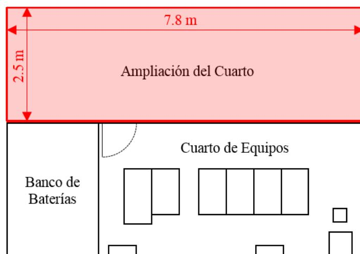
Se requiere la ampliación del cuarto de equipos actual, en un área mínima estimada de 19,5 m<sup>2</sup> (7,8 m x 2,5 m). El área a ampliar se demarca con el recuadro rojo en el gráfico anterior.
