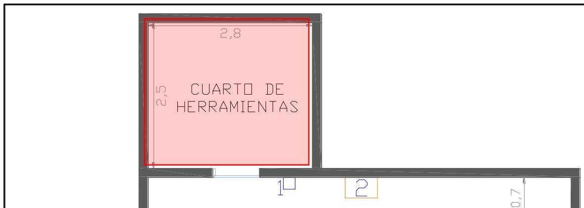
El **Contratista** debe realizar las adecuaciones necesarias en un cuarto adyacente al salón de equipos que se resalta con el recuadro rojo de la gráfica anterior. El área total disponible en este cuarto es de 7 m<sup>2</sup> y se deben realizar adecuaciones previas para la correcta instalación y puesta en operación de los equipos objeto del contrato.
