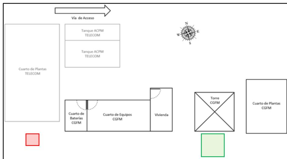
El espacio destinado para la instalación del transformador requerido se señala en el recuadro rojo del gráfico anterior. El espacio para la instalación de la TVRO se señala en el recuadro verde del gráfico anterior.
