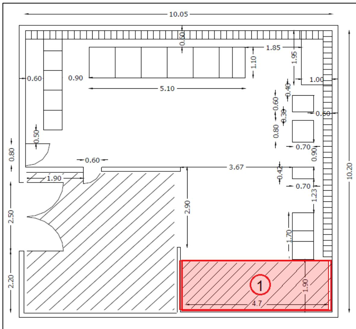
Para la instalación de los sistemas de transmisión y recepción satelital, **RTVC** dispone de un área mayor a 8 m<sup>2</sup> fuera del espacio para operación y mantenimiento. Esta área se demarca con el recuadro rojo en el gráfico anterior. Se deberán realizar adecuaciones menores para las instalaciones en este cuarto.
