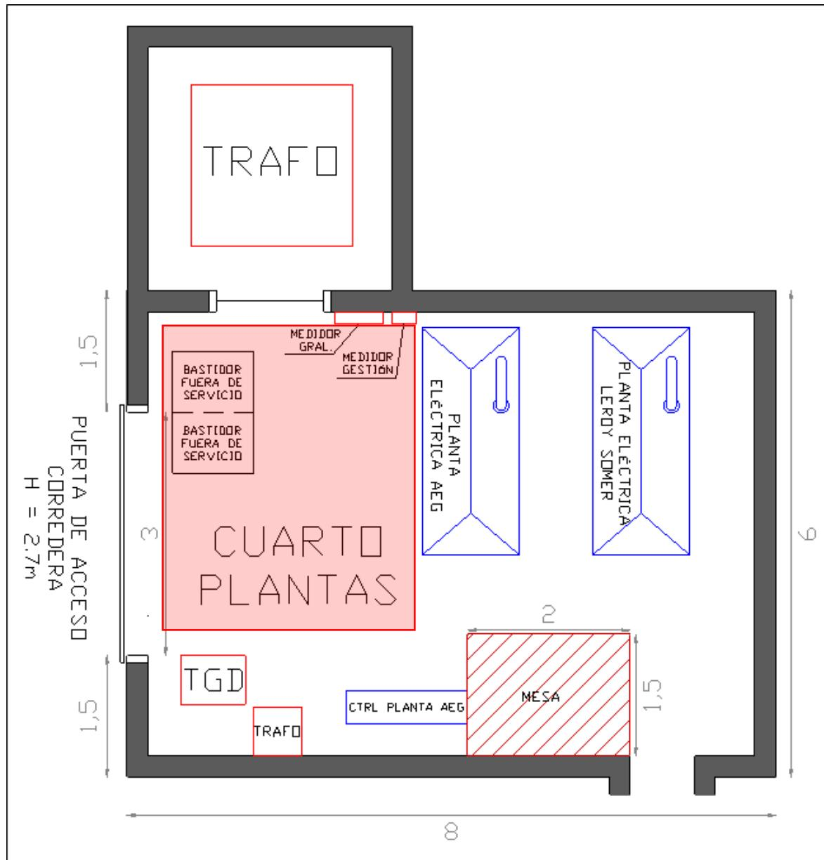
El área disponible para la instalación de la planta de emergencia, el tanque de reserva y los elementos asociados, es mayor a 15 m<sup>2</sup> y se muestra en la sección sombreada con rojo en el gráfico anterior. Para las instalaciones en este cuarto de plantas el **Contratista** debe realizar previamente adecuaciones menores.
