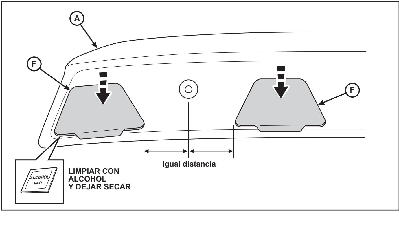
7. Retire los forros adhesivos exteriores de los cuatro (4) almohadilla de cinta adhesiva. Alinear el spoiler (A) con los orificios de montaje y con cuidado presione en su lugar en la tapa del maletero. Presione los dos clips (2) de montaje en su lugar. **Aplique 15 libras de presión durante 30 segundos para las almohadillas adhesivas para fijar el deflector de aire.**
