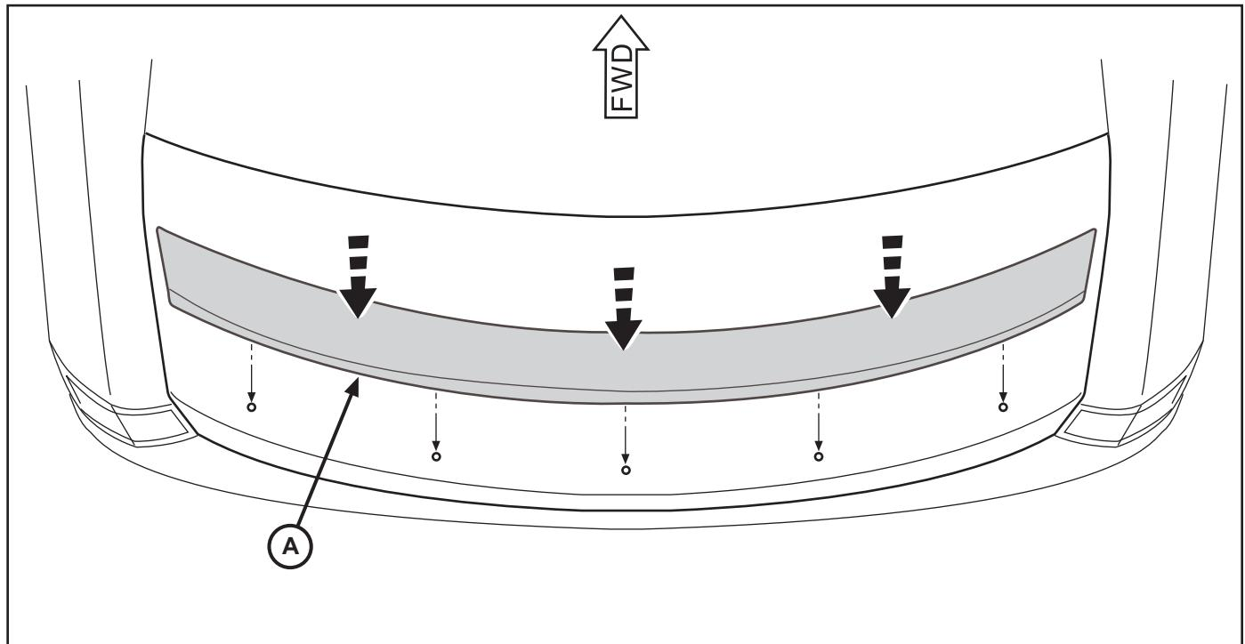
8. Abra la tapa del maletero y fijar las tuercas (3) de montaje de 10 mm para el alerón de la parte interior. Apriete a 6 Nm (4.5 ft. lbs.)
