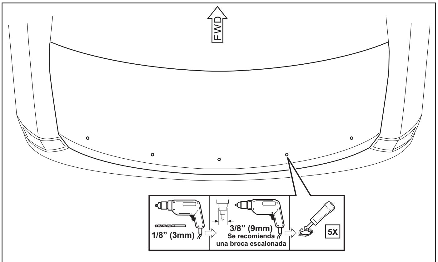
4. Utilice alcohol para limpiar el  rea donde se instalar  el spoiler. Tratar a todos los agujeros con inhibidor de  xido en el exterior y el interior de la tapa del maletero.
