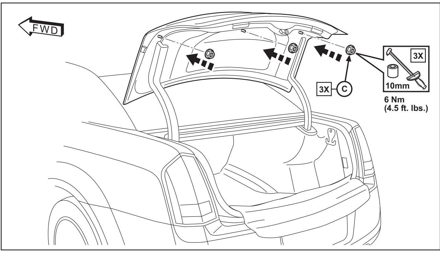
9. Réinstaller le panneau à l'intérieur du couvercle du coffre avec les clips (7) retirées précédemment. Réinstaller les deux (2) les bordures de protection. Retirez la toile de.
