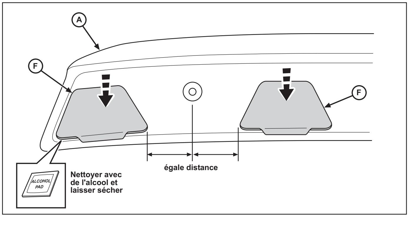
7. Retirer les garnitures adhésives extérieures des quatre (4) Tapis de adhésif. Alignez le Spoiler (A) avec les trous de fixation, puis appuyez délicatement en place sur le couvercle du coffre. Enclez les deux clips (2) de montage en place. **Appliquer £ 15 de pression pendant 30 secondes pour les plots adhésifs pour fixer le becquet.**
