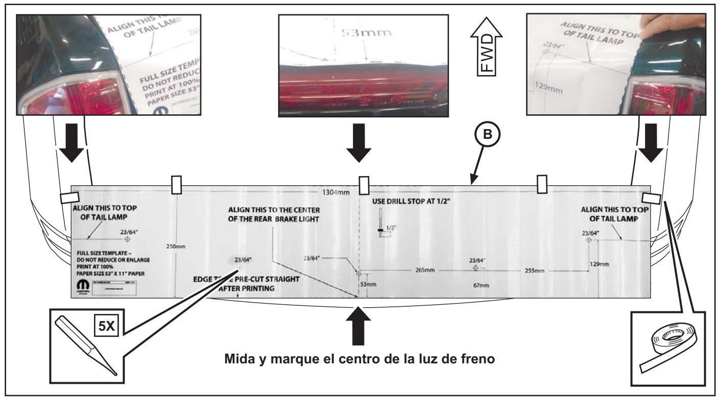
3. Retire la plantilla pero no descartes. Haga un  $1/8"$  (3mm) agujero piloto en los cinco (5) puntos marcados. Despu s de la perforaci n del agujero piloto, ampliar cada agujero para  $3/8"$  (9mm). **Se recomienda una broca escalonada.** Utilice una herramienta de desbarbar para limpiar cada agujero.
