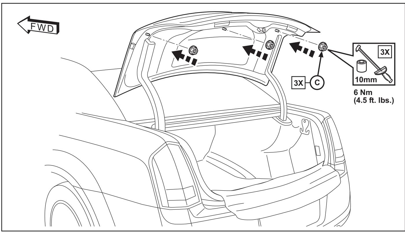
9. Vuelva a instalar el panel interior de la tapa del maletero con los (7) clips extraídos anteriormente. Vuelva a instalar los dos (2) protectores para la cuna. Retire el paño de recogida.
