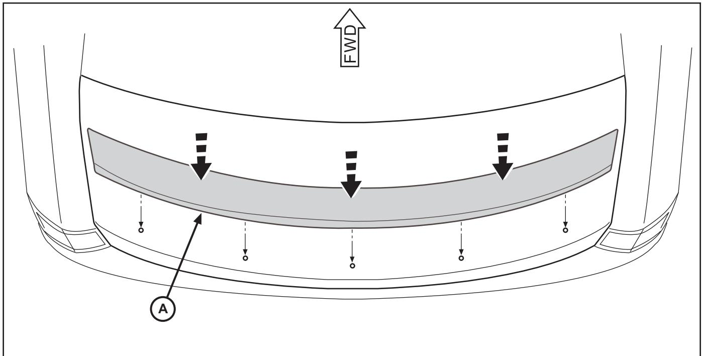
8. Ouvrez le couvercle du coffre et fixer les écrous (3) de montage 10mm à becquet de l'intérieur.
