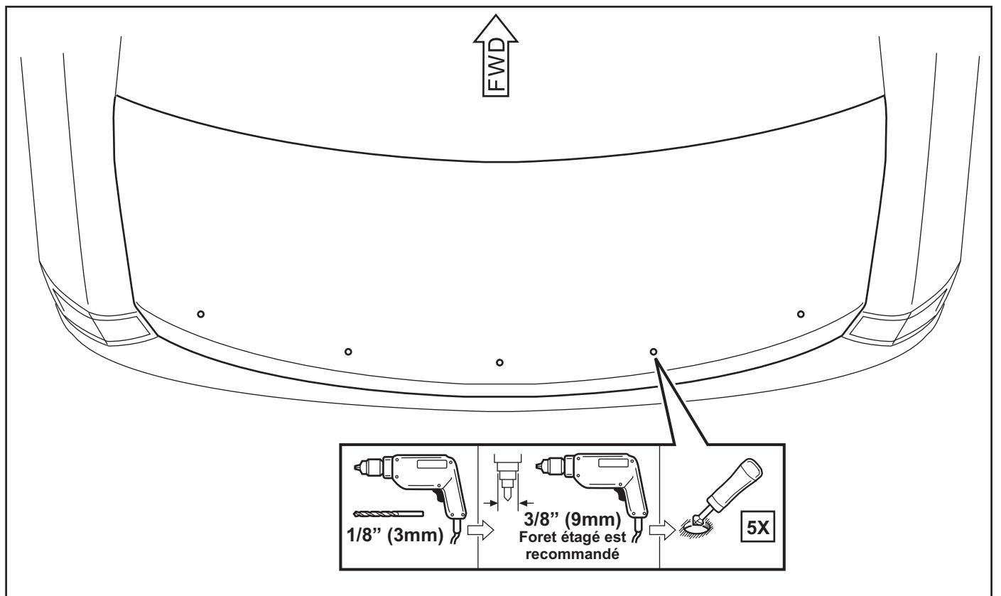
4. Utiliser de l'alcool pour nettoyer la zone où l'aile sera installé. Traiter tous les trous avec un inhibiteur de rouille à l'extérieur et à l'intérieur du couvercle du coffre.
