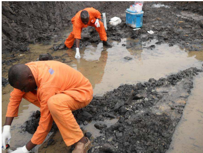
Photo 4: Prélèvements des échantillons d'eau pour leur analyse dans un Laboratoire de France
