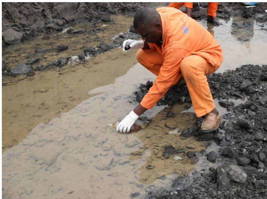
Photo 3: Suivi hebdomadaire de la qualité des eaux par PETROLOG pour en déterminer le degré de contamination
