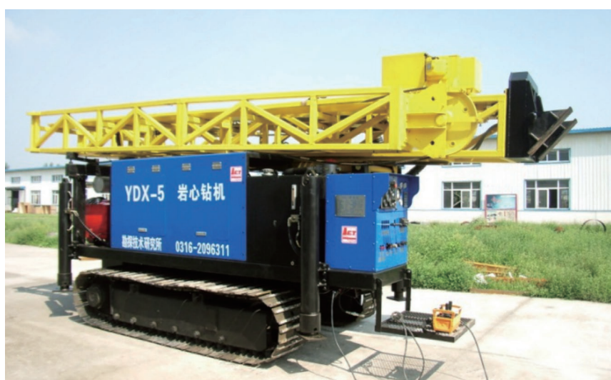
图9-2 YDX-5全液压岩心钻机
