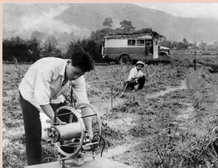
Rải dây tiến hành phương pháp đo điện từ - telua ở khu vực miền võng Hà Nội
