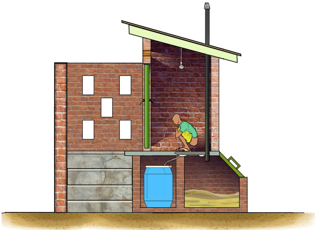
Figure 2-7: Urine Diversion Dry Toilet (UDDT)
