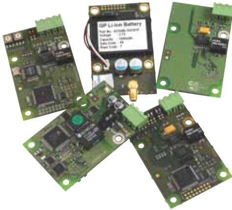
Fig. 51 Grundfos CIM modules
