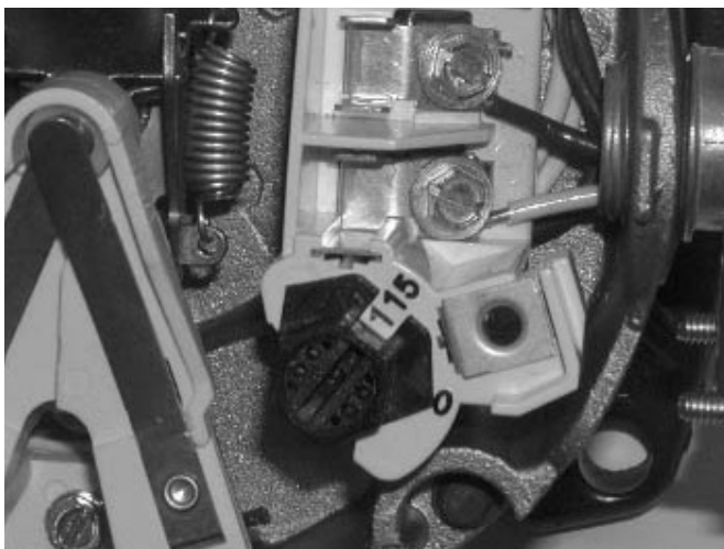
Figure 6 : Pour faire fonctionner le moteur sur le courant de 115 volts.
