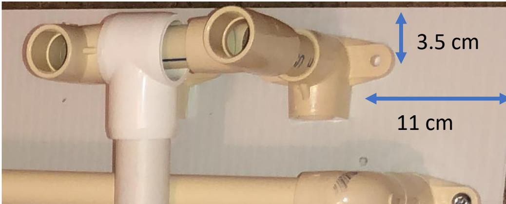
Mide 11 cm y 3.5 cm como se muestra en la imagen. Cuando tengas los 3.5 cm, haz una marca con un lápiz y coloca un codo de ala, tal y como se muestra en la foto para que puedas hacer una marca en el otro lado del codo con ala y taladrar. Taladra y atornilla. Mide 1.5 cm desde el tornillo, haz la marca, revisa que tengas 3.5 cm y taladra. Coloca el codo de ala, haz la marca, taladra y atornilla.
