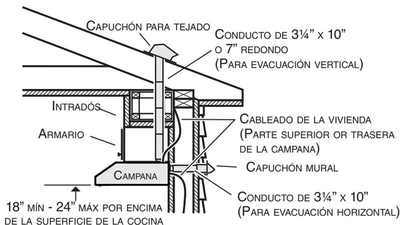
NOTA: Las distancias superiores a 24" son a discreción del instalador y del usuario.
