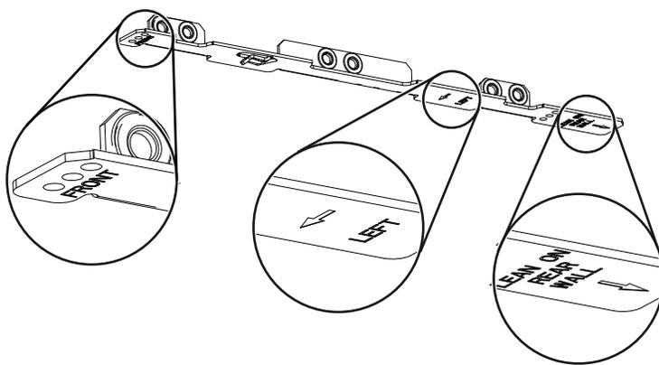
Consulte las marcas de los soporte para establecer el lado y la orientación correctos de la instalación (marcas en ingles solamente: *front* = frente, *left* = izquierda, *lean on rear wall* = apoyar contra la pared de atrás).
