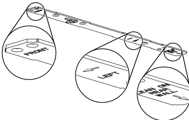
Consulte las marcas de los soporte para establecer el lado y la orientación correctos de la instalación (marcas en ingles solamente: *front* = frente, *left* = izquierda, *lean on rear wall* = apoyarse contra la pared de atrás).
