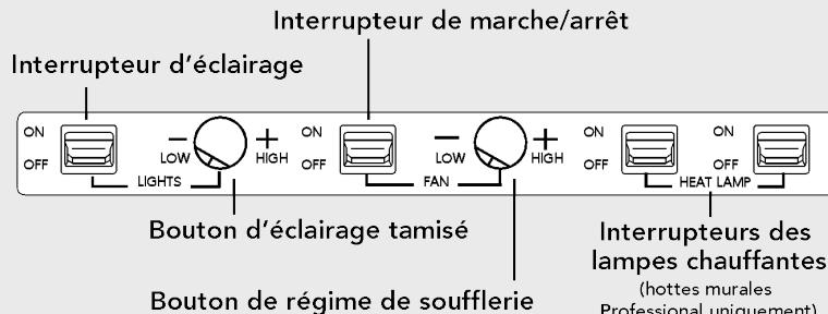
**Interrupteur de marche/arrêt**—Permet la mise en marche et l'arrêt de la soufflerie. À sa mise en marche, la soufflerie fonctionne au régime qui était le sien avant son dernier arrêt.
