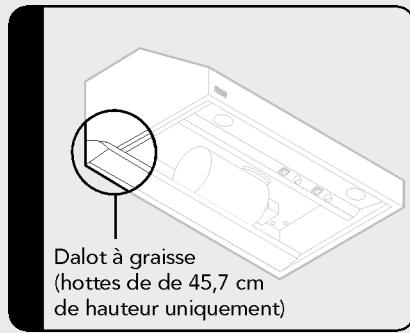
Lorsque vous nettoyez les filtres des hottes de 45,7 cm de hauteur, retirez toujours la graisse du dalot et nettoyez en faisant tremper dans un évier rempli d'eau savonneuse chaude.
