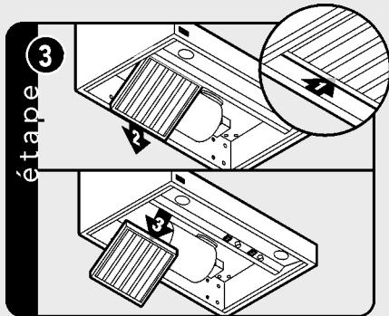
Glissez le filtre vers l'avant pour le dégager du rebord arrière. Abaissez l'arrière du filtre, puis glissez l'avant pour le retirer.
