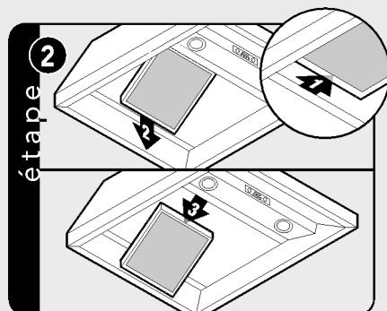
Glissez l'avant du filtre par-dessus le rebord avant. Poussez l'arrière du filtre vers le haut, puis glissez-le par-dessus le rebord arrière.
