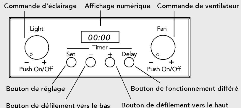
**Bouton d'éclairage**—Appuyez une fois dessus pour allumer les lumières. Rappuyez pour les éteindre. Tournez dans le sens horaire pour augmenter l'intensité lumineuse et dans le sens anti-horaire pour la diminuer. Le réglage de l'éclairage est tel qu'il était à la dernière extinction.
