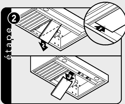
Glissez l'espacement vers l'avant pour le dégager du rebord arrière. Abaissez l'arrière de l'espacement, puis glissez l'avant pour le retirer.
