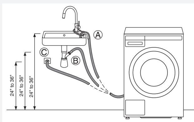
Se puede conectar el tubo de desagüe directamente al desagüe del lavabo por medio de un sifón. También en este caso el tubo debe hallarse a 600-900 mm por encima del suelo. El diámetro interior del tubo debe ser de 18 mm como mínimo. Vea la figura.
