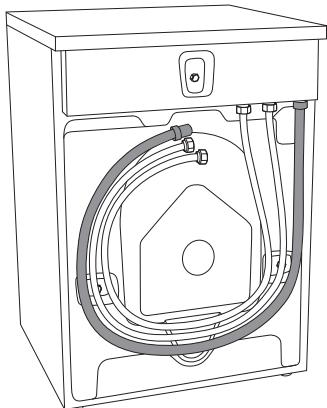
La máquina se suministra con la manguera de drenaje ya montada. La manguera debe extenderse hasta una pileta adecuada o un tubo de drenaje situados a una altura de 24" a 36" (610 mm a 914 mm) por encima de la base de la máquina. (Preferiblemente la altura más baja.) Asegúrese de que la manguera no tenga dobleces.
