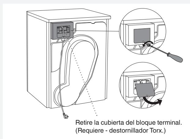
Retire la cubierta del bloque terminal.
