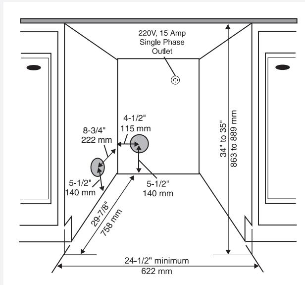
Las secadoras ASKO pueden instalarse debajo de un gabinete o mostrador con una altura mínima de 34" (864 mm). Debe haber un hueco de aproximadamente 1/2 " (12 mm) alrededor de la máquina incluido entre el borde posterior de la máquina y la pared posterior. El ancho de la abertura debe ser de al menos 24-1/2 " (622 mm).
