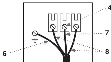
5. Retire el cable de tierra (verde con rayas amarillas) del tornillo conector de tierra externo y retirar del bloque de terminal central.
