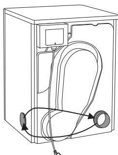
Las secadoras ASKO tienen un ducto de escape "estilo-T" que le permite conectar el conducto en la parte posterior, a la izquierda, o en el lado derecho
