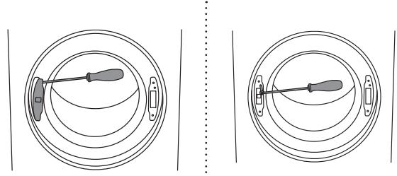
**3** Con un destornillador retirar el obturador del bloqueo de la puerta y desenroscar el tornillo del bloqueo de la puerta.
