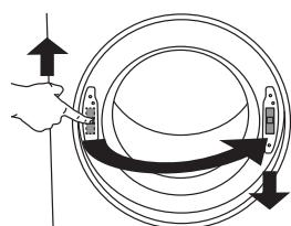
**4** Empujar hacia arriba el bloqueo de la puerta y retírelo. Moverlo al otro lado y empujarlo hacia abajo.
