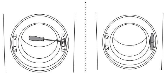
**5** Atornillar el tornillo en el bloqueo de la puerta. Volver a instalar el obturador del bloqueo de la puerta.
