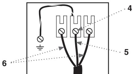
5. Conectar el cable de tierra (centro) del cable de alimentación al centro, tornillo terminal de color plateado. Apretar el tornillo
