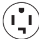
Tomacorriente de 4 hilos (14-30R)
