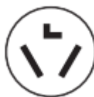
Tomacorriente de 3 hilos (10-30R)
