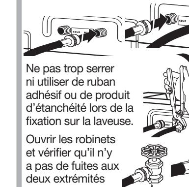
Ne pas trop serrer ni utiliser de ruban adhésif ou de produit d'étanchéité lors de la fixation sur la laveuse.
