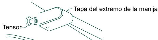
3. Ajuste ambos tornillos en las capas de terminación de la manija, girando la llave hexagonal 1/8" en sentido horario, hasta que la manija deje de estar floja o caiga de su montaje. Aún no ajuste completamente. **NOTA:** Al instalar manijas horizontales Statement, posicione la manija de modo que el tornillo de ajuste mire hacia abajo.
