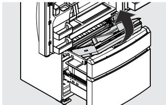
3. Desenganche los 4 sujetacables presionando los lados del clip y empujándolos a través de la abertura.
