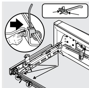
4. Retire el tornillo y el sujetador de retención y desconecte el arnés.
