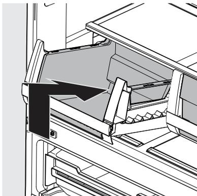
Incline el compartimento hacia arriba para volver a instalarlo
