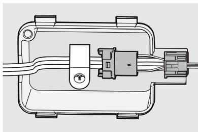
4. Vuelva a colocar el arnés eléctrico posicionando los sujetadores de cable sobre las marcas negras del arnés y empuje los 4 sujetadores de cable a través de las aberturas en el riel para asegurar el arnés en su lugar.
