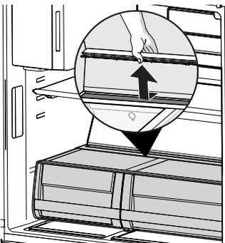
Extracción de la membrana del control de humedad automático
