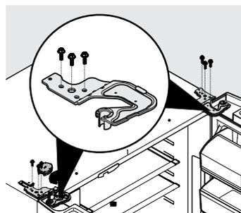
7. En ciertas circunstancias, es posible que deba retirar las bisagras inferiores para limpieza. Para acceder a las bisagras inferiores, extienda primero el cajón de temperatura Custom-Flex. Desatornille los 3 tornillos de la bisagra inferior y deslice la bisagra hacia adentro.
