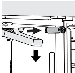
**Para retirarlo:** Tire de la cubierta y esta se desprenderá y permitirá acceder al filtro. Empuje el extremo/la cara del filtro para retirarlo de la unidad y deséchelo.
