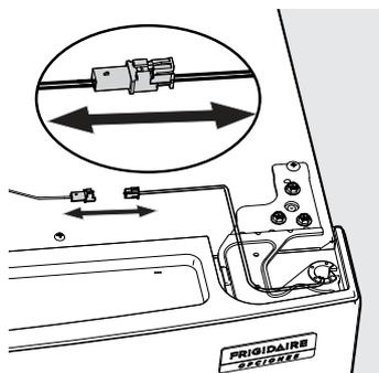
5. Tire de la tubería de agua con cuidado hacia arriba para separarla de la puerta.
