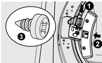
Réinstallez la vis à gros filetage
