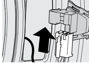
2. Faites glisser le capuchon de borne sur l'arrière de la plaque de la charnière jusqu'à ce que les languettes s'engagent en place.
