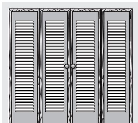
Portes à persiennes pliantes à deux vantaux avec ventilation de 120 po<sup>2</sup>
