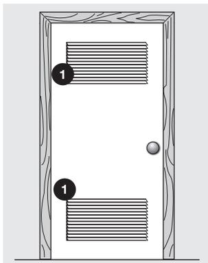
1. Porte d'aération de 774,2 cm<sup>2</sup> (120 po<sup>2</sup>) à deux vantaux égaux de 387,1 cm<sup>2</sup> (60 po<sup>2</sup>)
