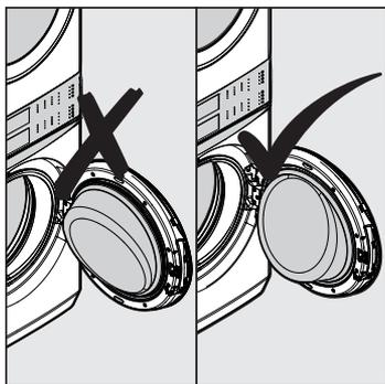
3. Branchez la laveuse, puis fermez la porte. Contrôlez le verrouillage correct de la porte en lançant un cycle d'essai : le verrou doit s'enclencher et la porte ne doit pas pouvoir être ouverte avant l'interruption ou l'annulation du cycle.
