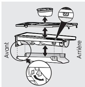
5. Rincez le tiroir du distributeur, les couvercles et le bouchon du détergent avec de l'eau chaude du robinet pour éliminer les traces des poudres et liquides accumulés. Une quantité importante de résidu d'assouplisseur peut être le signe d'une mauvaise dilution ou de la nécessité d'effectuer un nettoyage plus fréquent.
