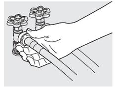
6. Serrez à la main jusqu'à ce qu'ils soient bien serrés. Serrez ensuite chaque raccord d'alimentation de 2/3 de tour à l'aide de pinces. **Ne pas plier, tordre, ni pincer les tuyaux d'entrée d'eau.**
