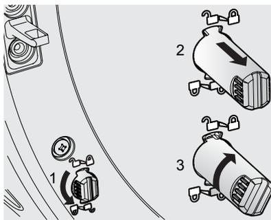
Pour désengager le support, faites-le tourner pour le déverrouiller, poussez-le vers l'intérieur et faites-le tourner en position verrouillée.
