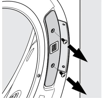
2. Retirez la vis qui maintient le couvercle à charnière. Conservez la vis et le couvercle pour la réinstallation.
