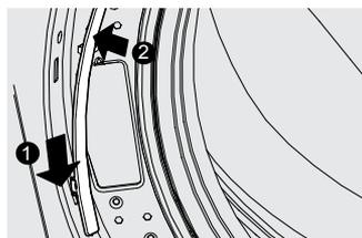
2. Insérez le faisceau de câblage dans le loquet de la porte.
