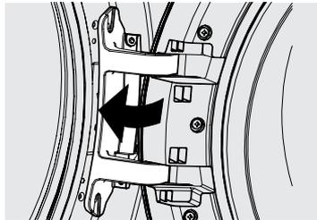
4. Réinstallez les quatre vis retirées précédemment : d'abord les deux vis avant, puis les deux vis latérales.
