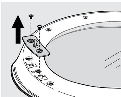
4. Retirez les huit vis restantes à l'aide d'un tournevis à bout carré n° 2. Conservez les vis pour la réinstallation.
