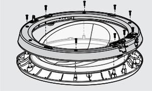
2. Soulevez légèrement la cuvette de la porte, puis tournez-la à 180 degrés en la replaçant sur la porte extérieure.
