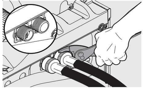
5. Raccordez le tuyau d'entrée d'eau CHAUDE à l'alimentation en eau CHAUDE et le tuyau d'entrée d'eau FROIDE à l'alimentation en eau FROIDE.
