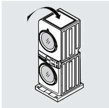
3. Les personnes à l'avant et à l'arrière de l'appareil doivent maintenir la base en place tout en déplaçant l'appareil vers l'arrière de la plaque de séparation en polystyrène, jusqu'à ce que les deux pieds arrière de l'appareil soient fermes sur le sol.
