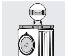
2. Utilisez une clé à molette pour régler les pieds de nivellement de manière à ce que l'appareil soit stable d'un coin à l'autre et à niveau à l'avant comme à l'arrière et des deux côtés.
