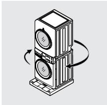
4. Tout en maintenant l'appareil en place en tout temps, inclinez-le vers l'arrière de manière à ce que la partie inférieure de l'appareil touche le sol. Demandez à la personne à l'arrière de maintenir l'appareil pendant que la personne à l'avant retire la plaque de séparation en polystyrène du dessous de l'appareil.
