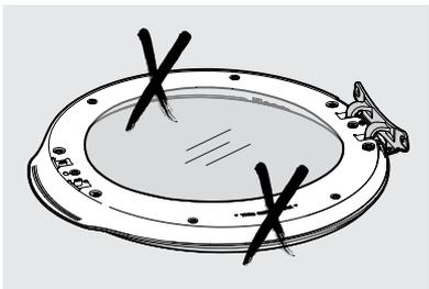
5. Soulevez l'anneau métallique et faites-le pivoter de 180 degrés, pour le réaligner sur le cadre intérieur. Assurez-vous que le joint n'est pas séparé de l'anneau métallique.
