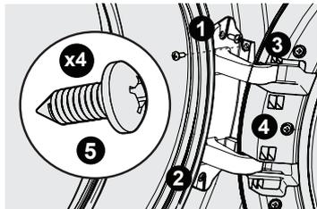
Réinstallez la vis à filetage fin
