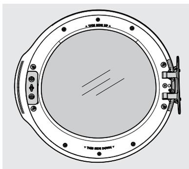
7. Réinstallez les huit vis à l'aide d'un tournevis à bout carré n° 2.
