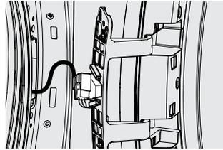
3. Insérez les tiges de positionnement de la charnière dans le trou précédemment recouvert par le cache en plastique. Appuyez sur l'avant de la charnière pour enclencher les autres tiges de positionnement en place.
