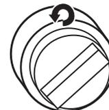
Si el quemador no se enciende, verifique la alineación de la tapa. Si el quemador sellado igualmente no se enciende, no lo repare usted mismo. Póngase en contacto con un especialista en reparación competente.
