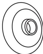
Arandela de soporte (para usar con tornillo puntiagudo de cabeza hexagonal)
