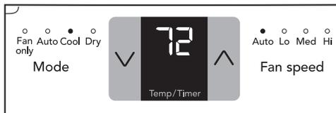
Nota: En este modelo, el ventilador permanece encendido todo el tiempo y el compresor se enciende y se apaga, según si se alcanza o no la temperatura de la habitación.
