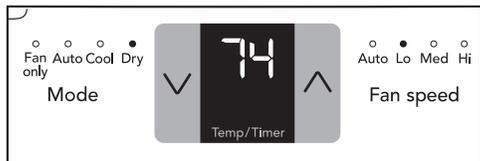
Nota: En este modo, el aire acondicionado funcionará como un deshumificador, pero enfriará la habitación mientras tanto. Se puede ajustar la temperatura entre 62 °F (17 °C) y 86 °F (30 °C) y se mantendrá la velocidad del ventilador en "Lo".
