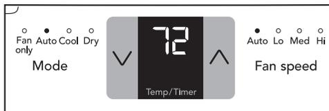
Nota: Este modo es una combinación fija del modo Frio y la configuración de velocidad del ventilador automática. En este modo, no se puede seleccionar la velocidad del ventilador manualmente.
