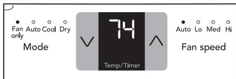
Nota: Use esta función sólo cuando no se está enfriando lo suficiente, ya sea por circulación de aire en la estancia, o por aire manido del escape en algunos modelos. (Recuerde abrir los conductos de ventilación mientras usa esta función, pero manténgalos cerrados durante la operación en frío para conseguir la máxima eficiencia). Puede escoger la velocidad de ventilador que prefiera.
