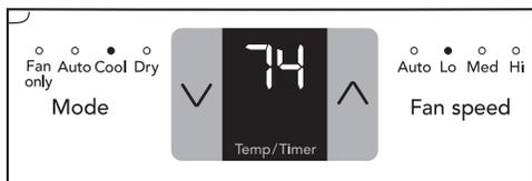
Nota: Se puede seleccionar la velocidad del ventilador entre cuatro configuraciones: Auto (Automático), Lo (Bajo), Med (Medio) y Hi (Alto), a no ser que se ejecute en modo "Automático" o "Seco", o esté activada la función de reposo.
