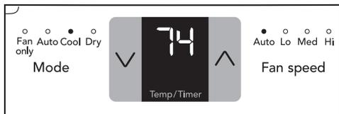
Nota: Pulse una vez o mantenga presionado tanto el botón arriba (∧) como el botón abajo (∨) hasta que se muestre la temperatura deseada en la pantalla. Esta temperatura se mantendrá automáticamente entre 62 °F (17 °C) y 86 °F (30 °C). Si quiere que la pantalla muestre la temperatura actual de la estancia, consulte la sección "Para operar sólo en modo ventilador".
