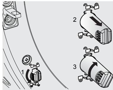
Para desenganchar el soporte, gírelo para desbloquearlo, empuje el soporte hacia adentro y gírelo para bloquear la posición.
