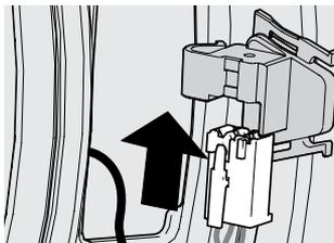
2. Deslice la tapa del terminal en la parte posterior de la placa de la bisagra hasta que las lengüetas encajen en su lugar.
