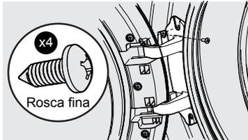
3. Sostenga la puerta con una mano sosteniendo el área de la manija y una mano sosteniendo la bisagra. Mientras sostiene la puerta en la bisagra, presione firmemente con la otra mano hasta que los pasadores de ubicación en la parte posterior de la placa de la bisagra se disloquen del panel frontal.
