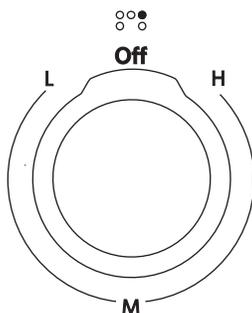
Les boutons de commande peuvent être réglés à n'importe quelle puissance entre "H" (élevée) et "L" (basse). Pour régler, enfoncer et tourner le bouton au réglage souhaité.
