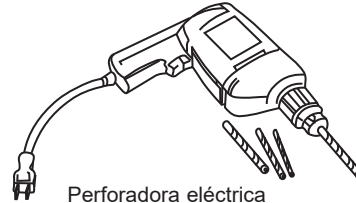
Perforadora eléctrica con mechas de 1/8" y 3/8"
