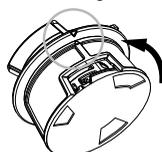
Tournez la grille dans le sens contraire des aiguilles d'une montre jusqu'à ce que les flèches soient alignées, comme sur l'illustration.
