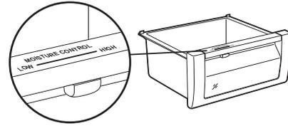
Para sacar el cajón deslícelo sacándolo de su tope. Luego, a cada lado del cajón, localice el nivelador negro en las correderas y levántelo hasta que el cajón se separe de las correderas. Jale el cajón y sáquelo completamente.
