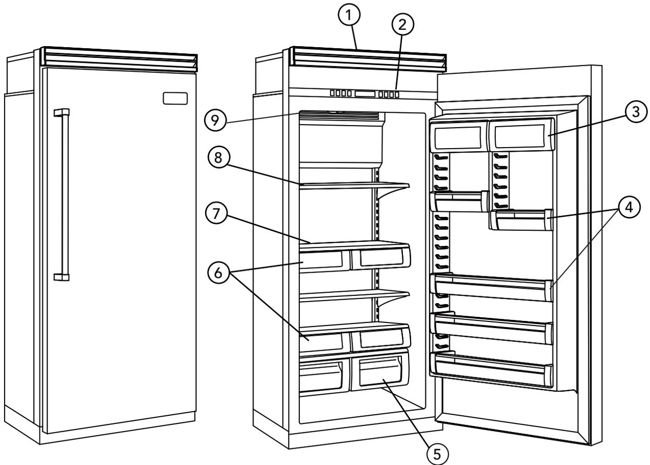
1. Compresor de CC y velocidad variable Overdrive™ y condensador Super Clog-Resistant™
