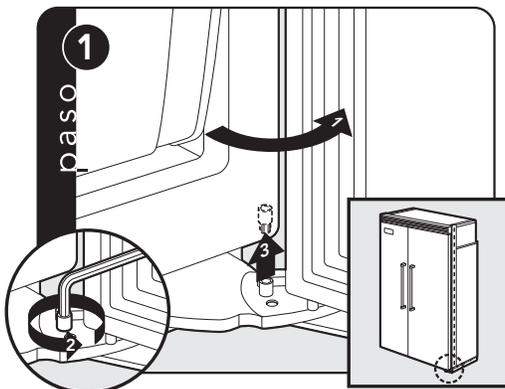
Abra la puerta del refrigerador para tener acceso al tope de la puerta y al tornillo con reborde.
