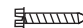
Vis de 1 à 3 po pour la fixation du plénum aux éléments de charpente.
