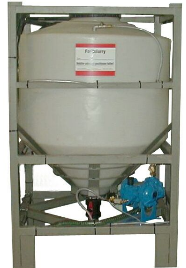
Standbehälter mit Doppelmembranpumpe passgenau zum Lieferbehälter „Ufo“
