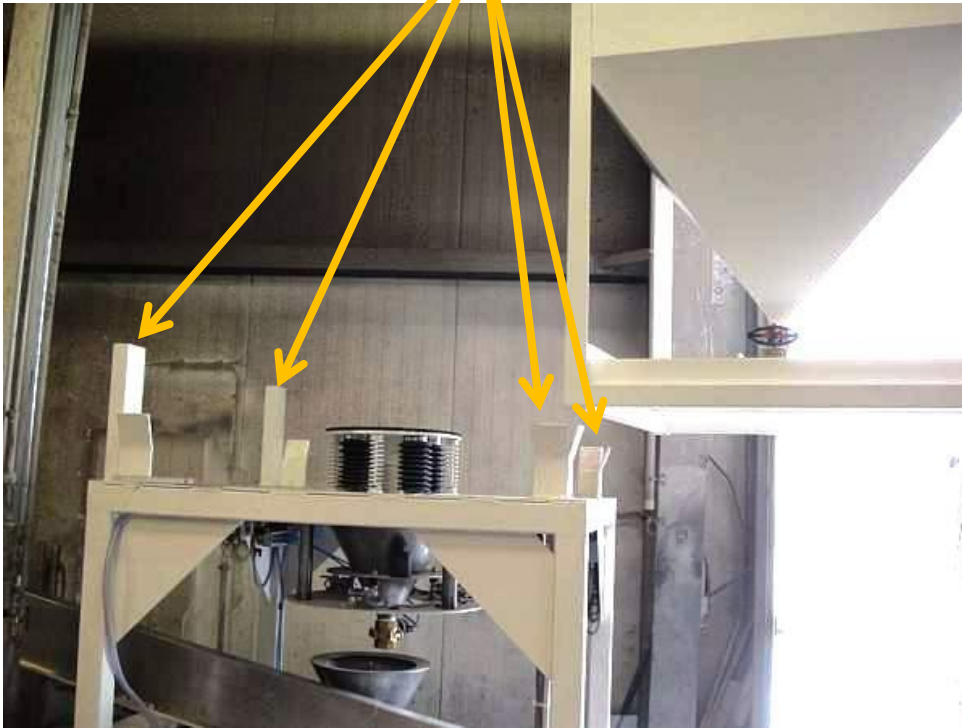
Führungsschienen zur korrekten Positionierung des Containers
