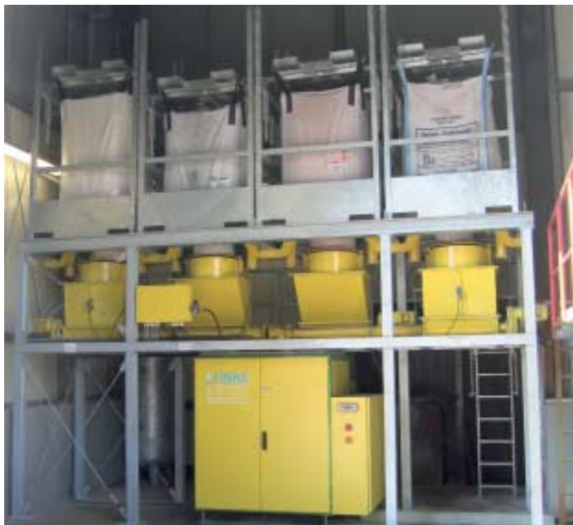
Abb. 2 Pneumatisch arbeitende Pulverdosiervanlage der Firma Finke GmbH für vier Farben.
