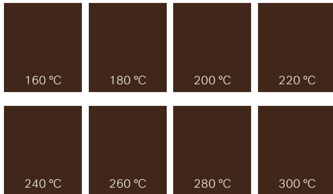
Bild 8: Farbentwicklung von Bayferrox® 303 T (Manganferrit) in einem Beschichtungssystem auf Basis von Phenyl-methyl-polysiloxan
