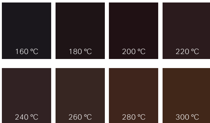
Bild 7: Farbentwicklung eines Eisenoxidschwarzpigmentes (Magnetit) in einem Beschichtungssystem auf Basis von Phenyl-methyl-polysiloxan
