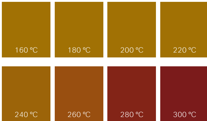
Bild 2: Farbentwicklung eines Eisenoxidgelbpigmentes (Goethit) in einem Beschichtungssystem auf Basis von Phenyl-methyl-polysiloxan
