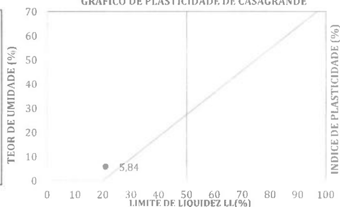
GRÁFICO DE PLASTICIDADE DE CASAGRANDE
