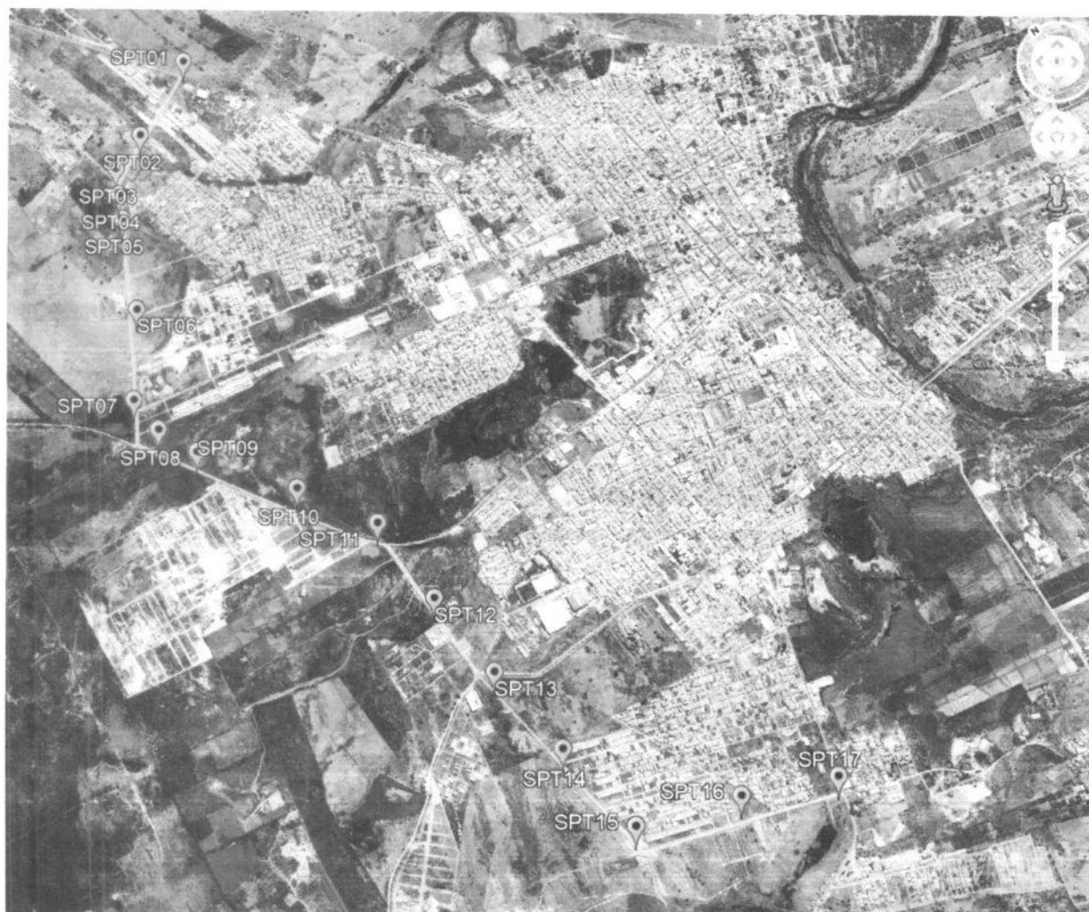
Figura 2 – Localização dos furos SPT no anel viário
