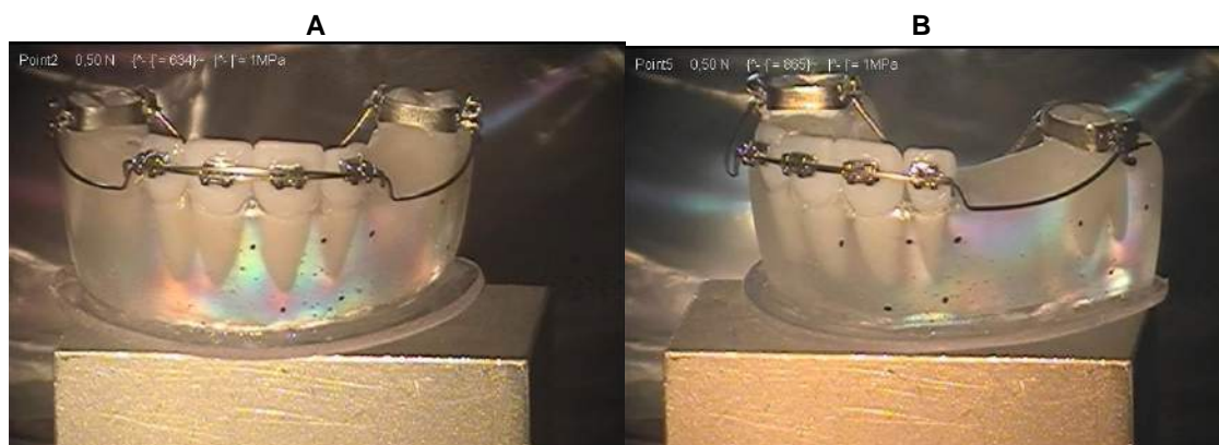
Figura 22 - Imagem dos dentes anteriores(a) e do molar(b) no polariscópio com modelo com BTP sem dobra distal do arco de intrusão (G1).
