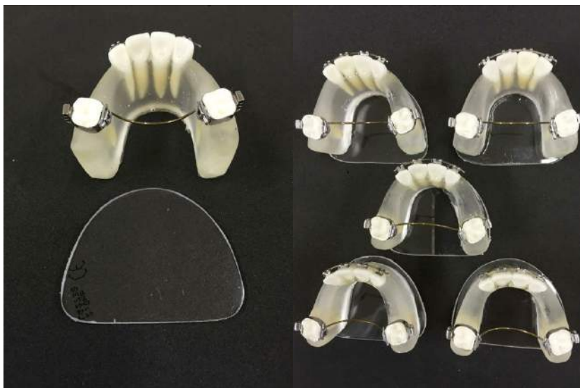
Figura 20 –Base modelo cristal (2mm) para fixação e estabilização dos modelos fotoelásticos
