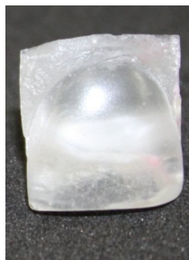
Figura 12 – Modelo de resina epóxica após polimento
