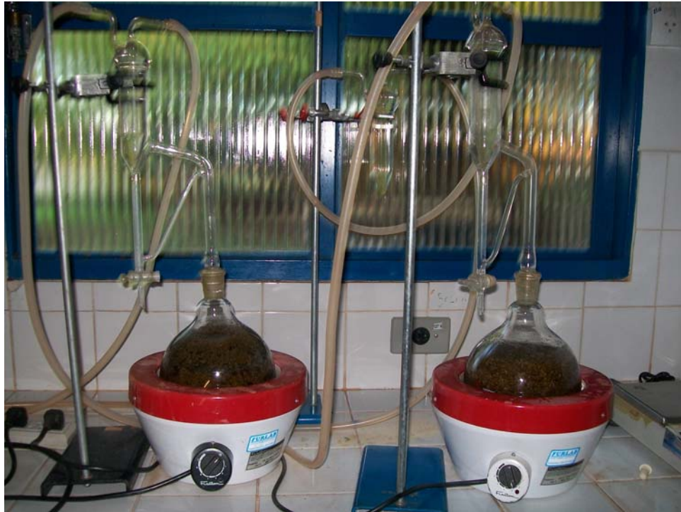
Figura 8 - Extração do óleo essencial de Melissa officinales L. com uso do aparelho Clevenger.
