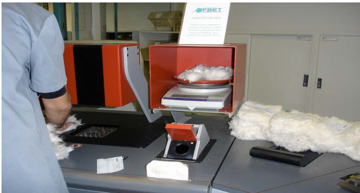
Figura 7. Classificação no aparelho HVI para se obter características tecnológicas de finura e resistência de fibra de algodão.
