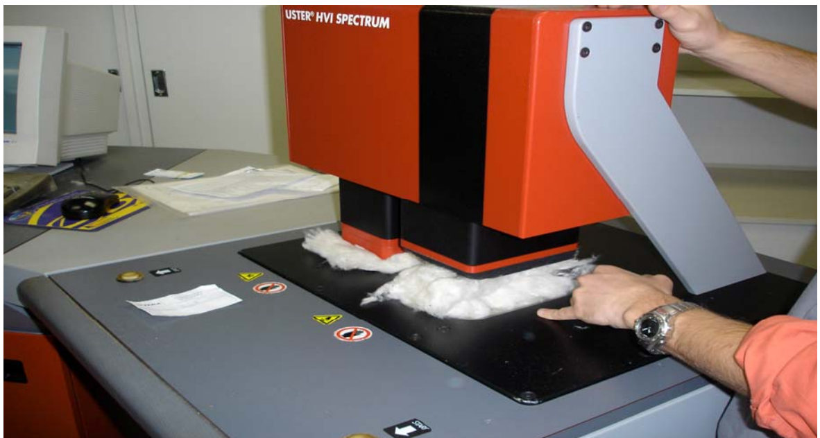
Figura 6. Classificação no aparelho HVI para se obter características tecnológicas de grau de cor e impurezas de fibras de algodão.
