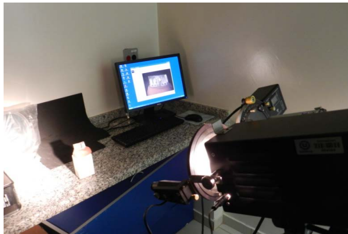
Figura 13 - Polariscópio de Reflexão (Vishay LF/Z-2, Malvern, USA) e Software específico (PSCalc 2.0)
