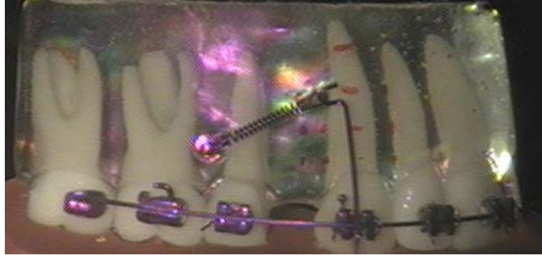
Figura 17 - Presença de franjas coloridas frente a um polariscópio de reflexão com a utilização do método power arm longo
