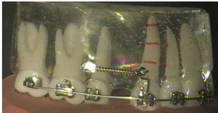
Figura 15 - Presença de franjas coloridas frente a um polariscópio de reflexão com a utilização do método power arm curto
