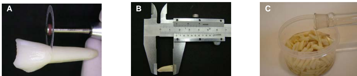
Figura 1 – Seccionamento do dente bovino com disco diamantado dupla face na medida inicial (A), conferindo posteriormente o comprimento das raízes obtidas com um paquímetro (B), armazenada-as em solução de timol após a limpeza (C).
